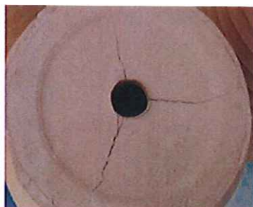
ภาพที่ 5 แสดงการทดสอบหัวหลังอบที่มีปัญหา
