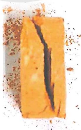
รูปที่ 4.8 ลักษณะการแตกหักของชิ้นงานเซรามิก
