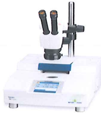
รูปที่ 2.17 เครื่องติฟเฟอร์นเซียสแกนนิ่งแคลอริมิเตอร์ [19]
