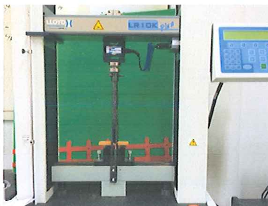
รูปที่ 3.3 การทดสอบความต้านทานแรงดัดโค้งของชิ้นงาน
