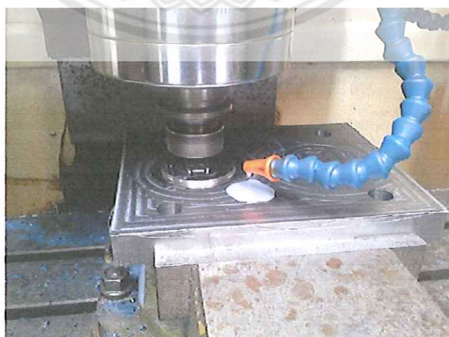
รูปที่ 4.23 แม่พิมพ์ที่เข้าเครื่องกัดซีเอ็นซี
