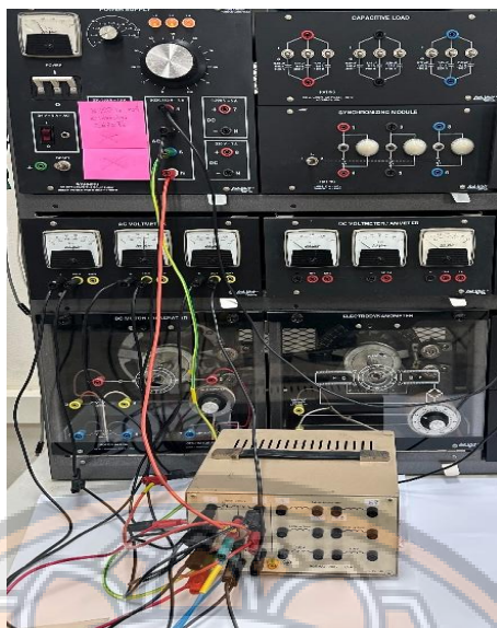
ภาพ 27 วงจรการทดสอบเปิดวงจรจากการทดลอง
