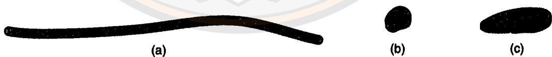
รูปที่ 2.7 แสดงความเป็นไปได้ของรูปร่างในวัสดุคอมโพสิต; (a) เส้นใย (b) อนุภาค (c) แผ่น [31]
