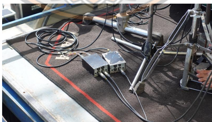
ภาพ 7 การเชื่อมต่อสัญญาณดรัมแมชชีนผ่าน DI Box
