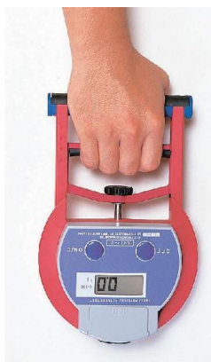
ภาพ 8 เครื่องวัดแรงบีบมือ (Hand Grip Dynamometer)
