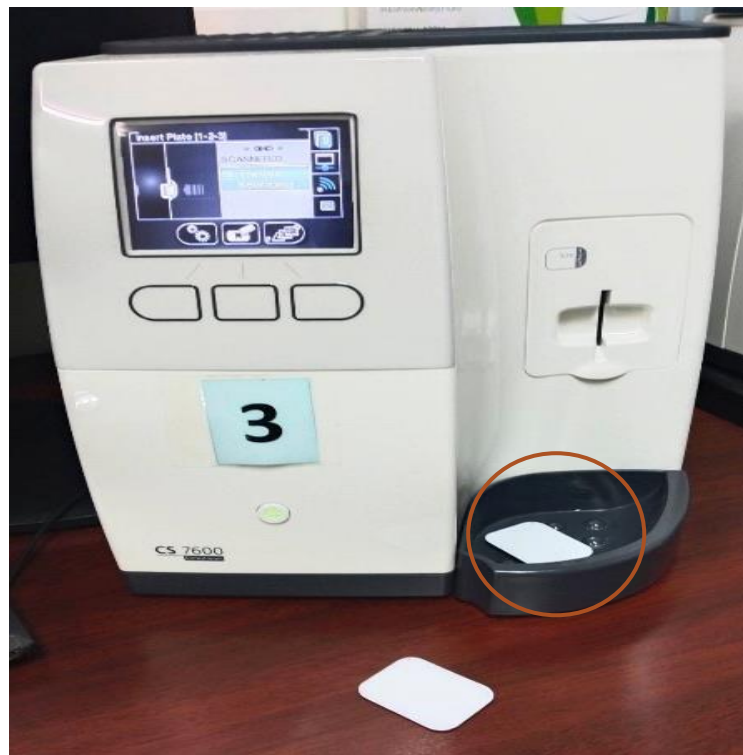
ภาพที่ 2.31 แสดงแผ่นสร้างภาพแบบดิจิทัลหลังจากใช้งานเสร็จสิ้น
