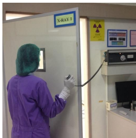
ภาพที่ 2.1 แสดงขณะถ่ายภาพรังสี ผู้ถ่ายภาพรังสีควรยืนอยู่หลังฉากตะกั่วกันรังสี
