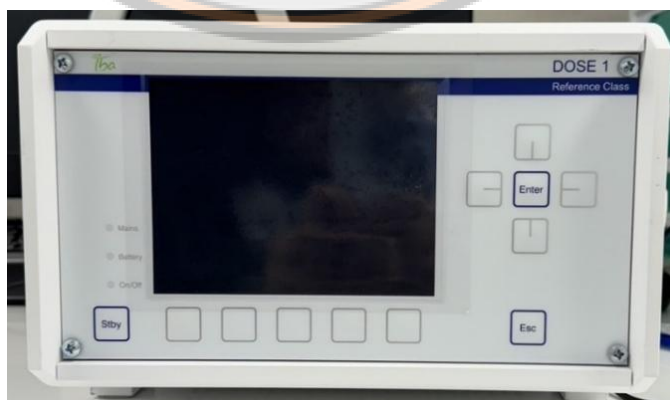
ภาพ 7 แสดง Electrometer ยี่ห้อ IBA รุ่น DOSE 1
