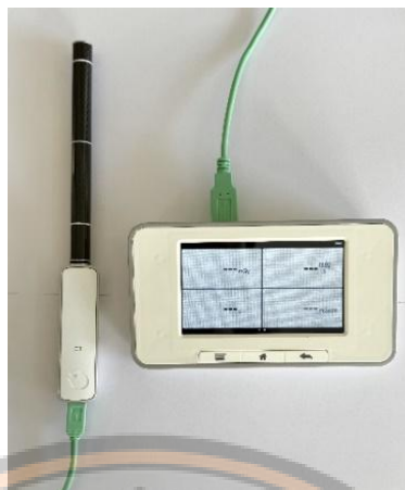
ภาพ 11 หัววัดรังสีชนิด Pencil ionization chamber ยี่ห้อ Raysafe รุ่น X2 CT และ Base Unit
