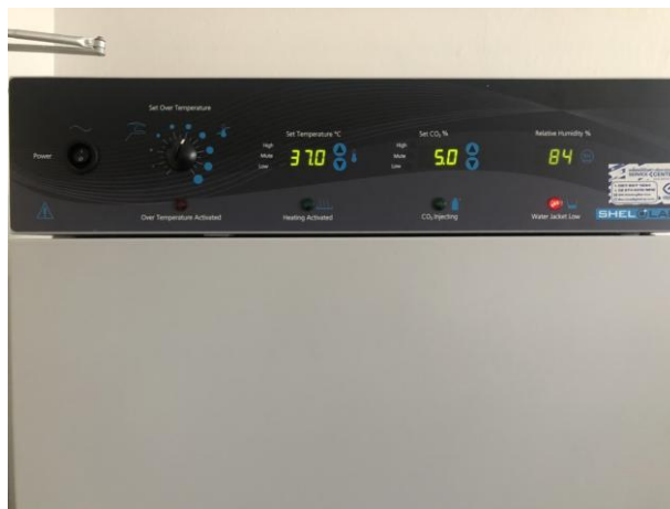
ภาพที่ 16 แสดงไฟแจ้งเตือน water jacket
