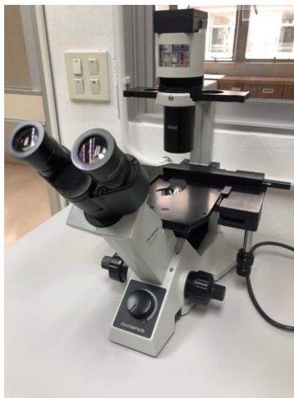
ภาพที่ 17 กล้องจุลทรรศน์ชนิดหัวกลับ (Inverted Microscope)
