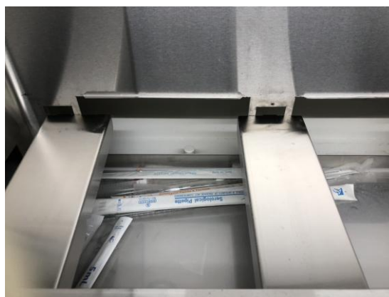
ภาพที่ 12 แสดงเศษวัสดุอุปกรณ์ที่หล่นอยู่ใน drain pan
