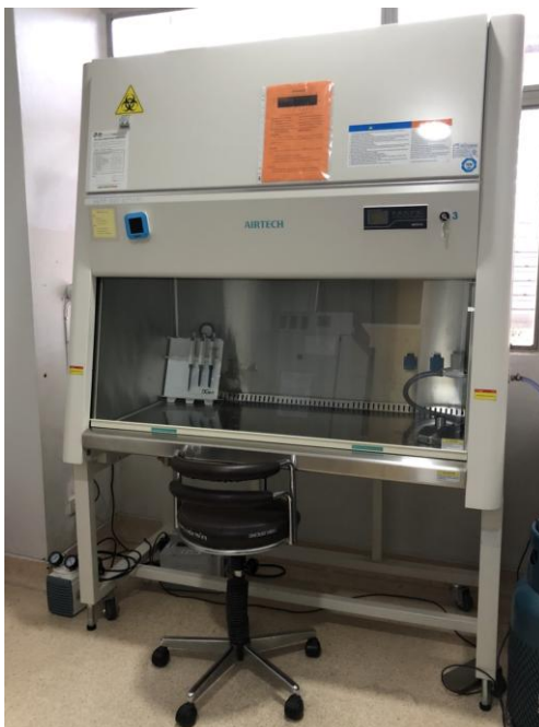
ภาพที่ 11 ตู้ชีวนิรภัย (Biosafety Cabinet Class II)
