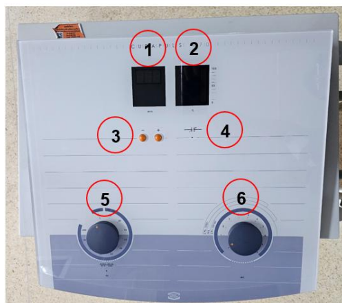
รูปที่ 16 แผงควบคุม โดยหมายเลข 1 แสดงจอภาพแสดงเวลาที่รักษา หมายเลข 2 แสดงจอภาพแสดงระดับ ความเข้ม หมายเลข 3 แสดงปุ่มตั้งเวลาในการรักษา หมายเลข 5 แสดงไฟแสดงการปรับคลื่น หมายเลข 6 แสดงปุ่มสำหรับเลือกใช้คลื่นแบบต่อเนื่องหรือแบบพัลส์ และหมายเลข 7 แสดงปุ่มปรับความเข้ม
