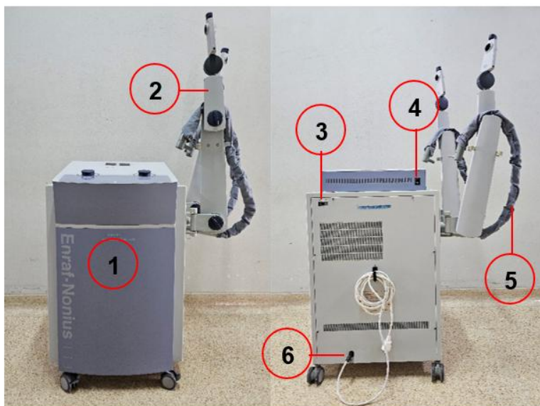
รูปที่ 15 ส่วนประกอบของเครื่องกำเนิดความร้อนลึกดด้วยคลื่นสั้น รุ่น Curapuls 970 โดย หมายเลข 1 แสดงตัวเครื่องหลัก หมายเลข 2 แสดงขาตั้งหรือแขนจับหัวส่งคลื่น หมายเลข 3 แสดง สวิตช์ระบบตัดไฟอัตโนมัติ หมายเลข 4 แสดงสวิตช์เปิด ปิดเครื่อง หมายเลข 5 แสดงสายอิเล็กทรอนิกส์ และหมายเลข 6 แสดงปลั๊กไฟ
