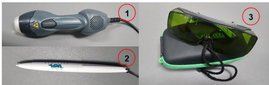
รูปที่ 20 หัวเลเซอร์และอุปกรณ์เสริม โดยหมายเลข 1 แสดงหัวเลเซอร์ หมายเลข 2 แสดงปากกา สำหรับใช้งานหน้าจอรบบสัมผัส และหมายเลข 3 แสดงแว่นตาป้องกันรังสีเลเซอร์
