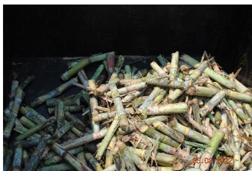
ภาพ 34 นำอ้อยใส่กล่องเพื่อวัดความหนาแน่นมวลรวมของอ้อย
