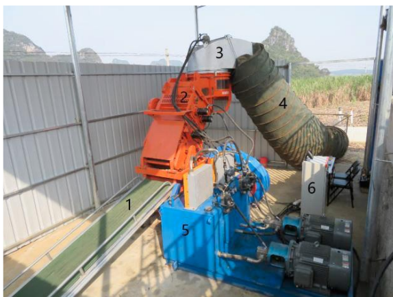
ภาพ 25 ชุดทดลองระบบทำความสะอาดอ้อย
