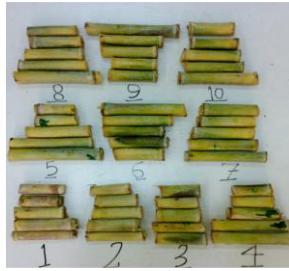
ภาพ 27 ปล้องอ้อยที่ใช้ในการศึกษาแรงที่ใช้ในการฉีกขาด
