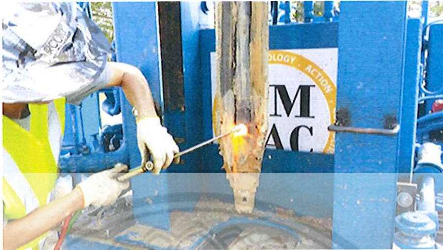
รูปที่ 6.7: แสดงการเชื่อมรอยแตกบริเวณหัวชุดเจาะ
