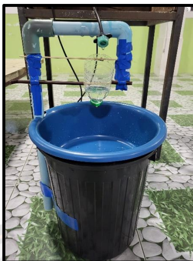
ภาพ 8 ภาพการสร้างแปลงเพาะถั่วงอกอัตโนมัติ
