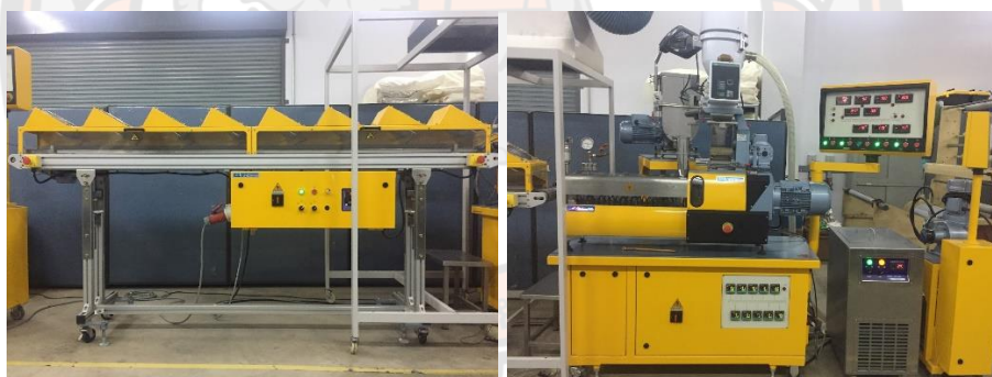
ภาพ 15 เครื่องผสมแบบเกลียวหอนคู่ (Twin screw extruder )
