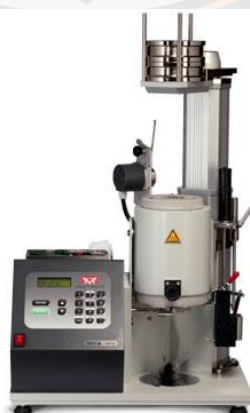
ภาพ 18 เครื่องทดสอบค่าอัตราการไหลของพลาสติก (Melt flow index)
