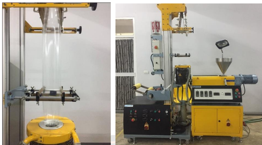
ภาพ 16 การขึ้นรูปฟิล์มพอลิเมอร์ผสมด้วยเครื่องหลอมอัดรีดเป่าฟิล์ม (Blow film extruder)
