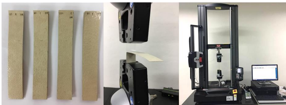
ภาพ 25 ตัวอย่างการดึงขึ้นงานการทดสอบการยึดเกาะ
