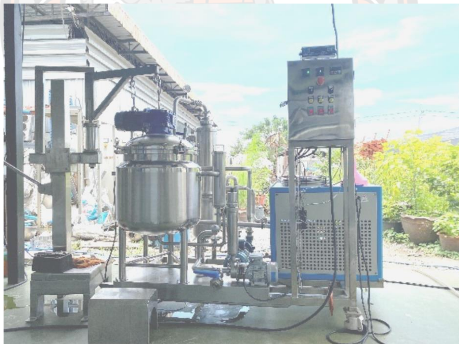
ภาพ 20 เครื่องกวนสับปรดด้วยเทคนิคการควบแน่นภายใต้สภาวะสุญญากาศ
