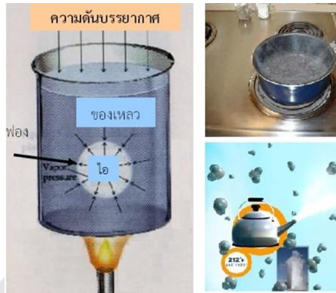
ภาพ 10 การเดือดของของเหลว เมื่อได้รับความร้อนจนความดันไอของสารเท่ากับความดันบรรยากาศ
