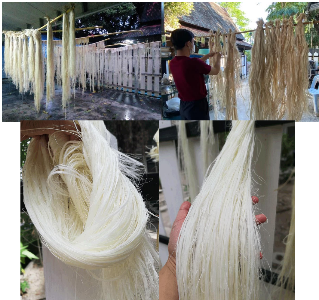
ภาพ 79 เส้นใยกล้วยที่แยกเรียบร้อยแล้วพร้อมเข้าสู่กระบวนการปรับสภาพเส้นใย
