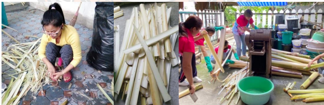
ภาพ 78 การแยกเส้นใยกล้วยด้วยเครื่องแยกกึ่งอัตโนมัติ
