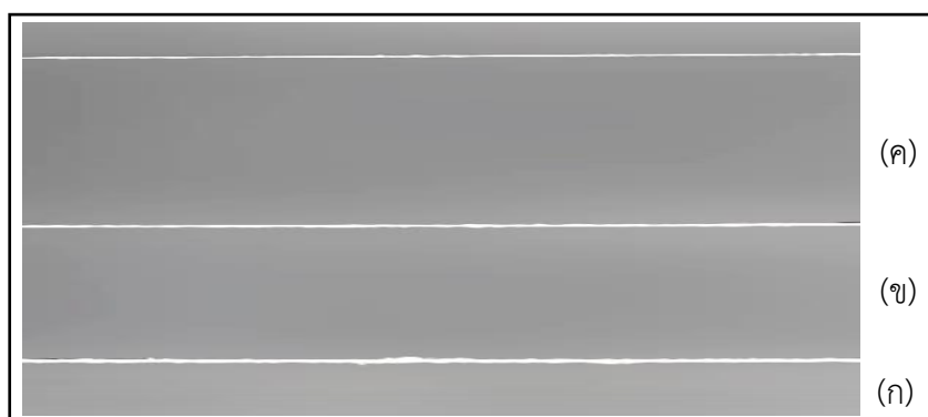
ภาพ 14 ตัวอย่างเส้นด้ายผสมเส้นใยกล้วย (ก) เบอร์ 5 (ข) เบอร์ 10 (ค) เบอร์ 16
