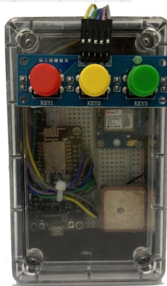
ภาพ 61 ระบบ GPS Tracking สำหรับแจ้งเตือนฉุกเฉินด้วยเซนเซอร์ระบุตำแหน่ง
