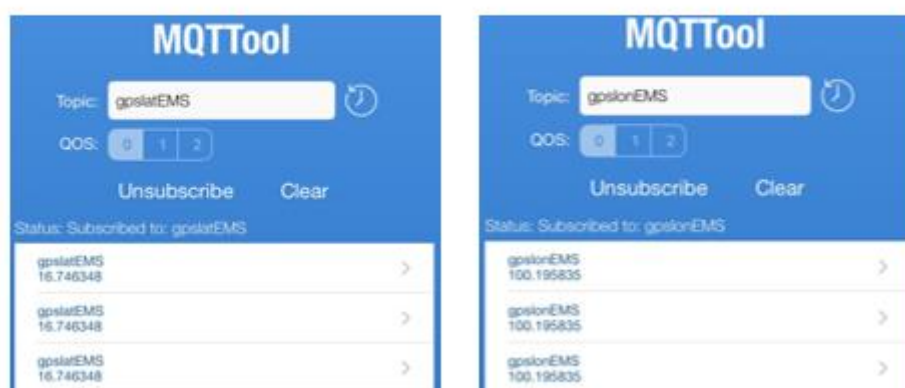
ภาพ 62 ข้อมูล GPS Tracking ที่เข้า MQTT โดย ( a ) เป็นค่าพิกัดละติจูด และ ( b ) เป็นค่าพิกัดลองจิจูด
