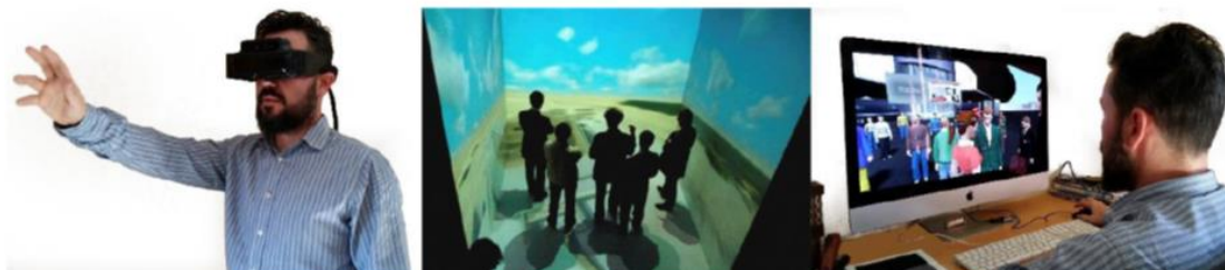
ภาพ 15 จอแสดงผลแบบสวมศีรษะ (Head-Mounted Display - HMD)
