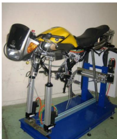
ภาพ 26 เครื่องจำลองการขับขี่รถจักรยานยนต์ที่พัฒนาขึ้นโดย INRETS-UEVE
