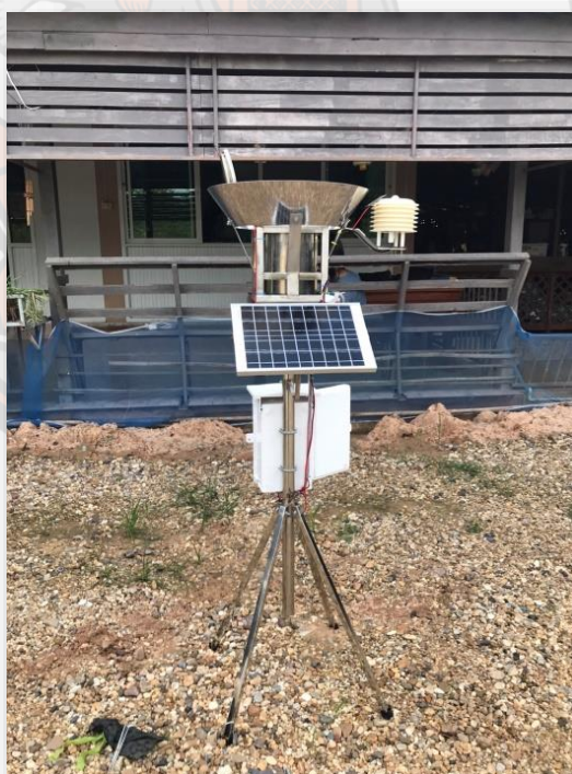
ภาพ 26 ตำแหน่งการติดตั้งอุปกรณ์เก็บตัวอย่างฝุ่นตก
