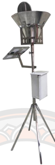
ภาพ 13 อุปกรณ์เก็บตัวอย่างฝุ่นตก (Dust-fall Jar) แบบอัจฉริยะ
