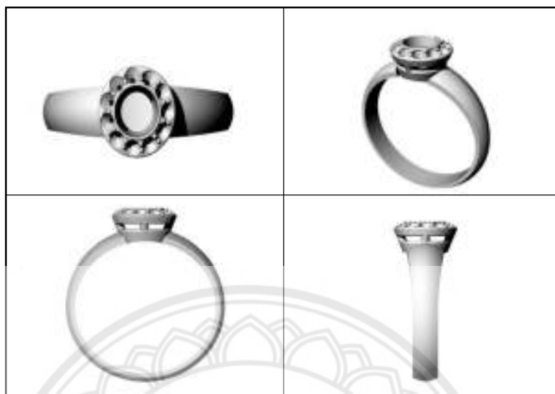
รูปที่ 4.1 แสดงการออกแบบแหวนล้อมเพชรด้วยโปรแกรม Rhinoceros
