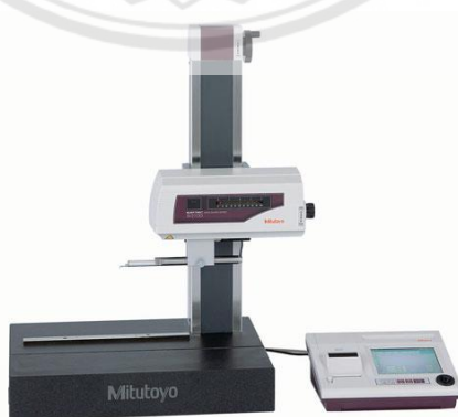
รูปที่ 4.9 เครื่อง Surface Measuring Instrument SurfTest-400 ยี่ห้อ MITUTOYO
