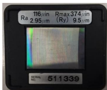
รูปที่ 4.10 ค่าตัวอย่างในการวัดความหยาบละเอียดของผิวงาน
