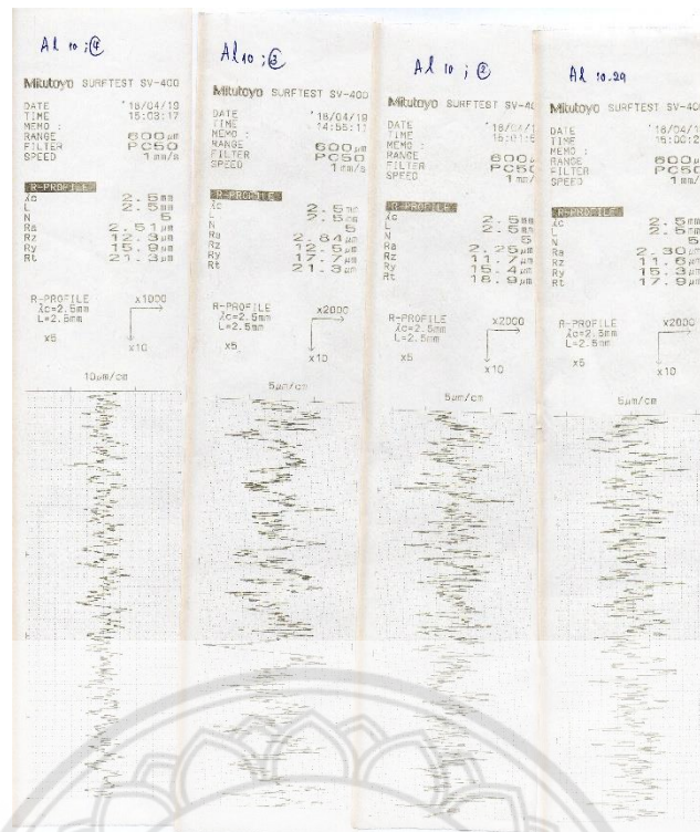
รูปที่ จ.7 กราฟความหยาบละเอียดผิวงานของชิ้นงานเพลาลูกมึนนิยม ที่กัดด้วยดอกกัดขนาด 10 มิลลิเมตร
