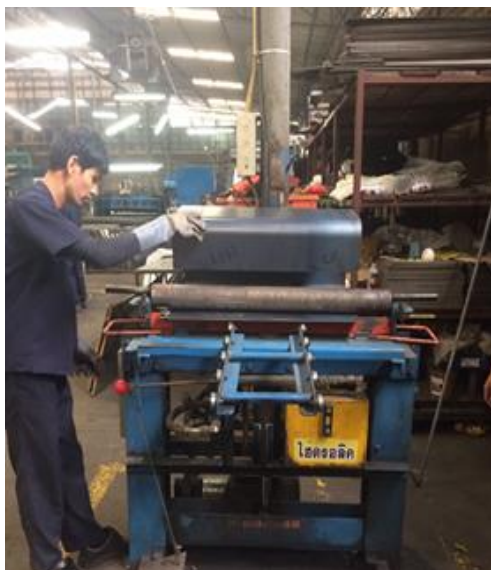
รูปที่ 4.2 การนำแผ่นเหล็กที่ได้จากการวัดระยะเข้าเครื่องตัดเหล็ก
