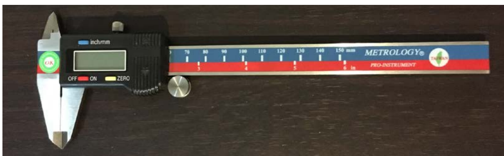
รูปที่ 3.4 เวอร์เนียคาลิปเปอร์แบบดิจิตอล
