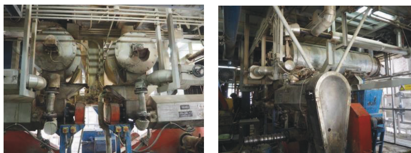
รูปที่ 3.16 Extruder (เครื่องรีดอาหารสัตว์ให้เป็นแท่ง)
