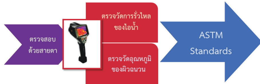
รูปที่ 3.27 กระบวนการตรวจวัดระบบท่อส่งจ่ายไอน้ำ
