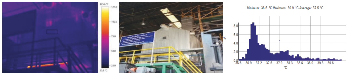
รูปที่ 4.10 อุณหภูมิผนังด้านหน้าห้องเผาไหม้
