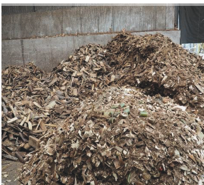
รูปที่ 3.5 แสดงเชื้อเพลิงที่ใช้ในการเผาไหม้ คือ ไม้สับ
