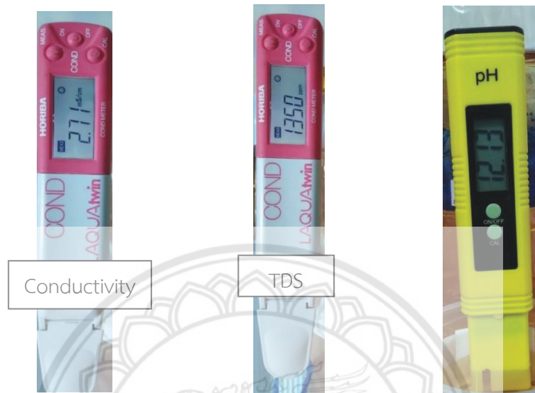
รูปที่ 4.6 การตรวจวัดน้ำ Blowdown
