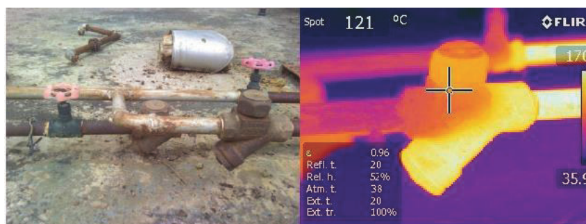
รูปที่ 2.14 การใช้กล้องถ่ายภาพความร้อนในการประเมินการรั่วไหล [6]
