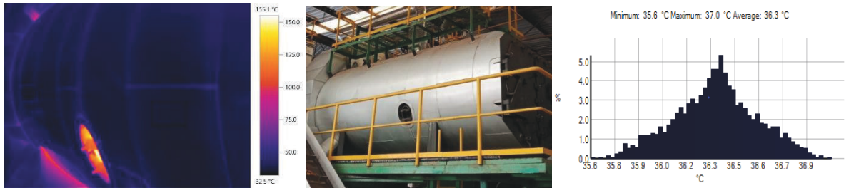
รูปที่ 4.14 อุณหภูมิผนังด้านข้างหม้อน้ำ
