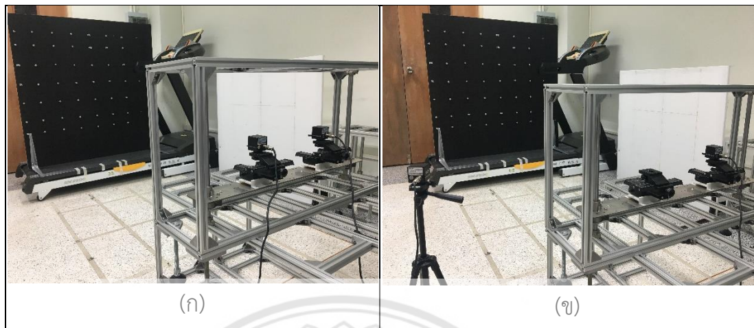
รูปที่ 3.13 การตั้งกล้อง webcam กับฉากอ้างอิง ระหว่างกล้องคูโกล์ (ก) และกล้องคูโกล์ (ข)
