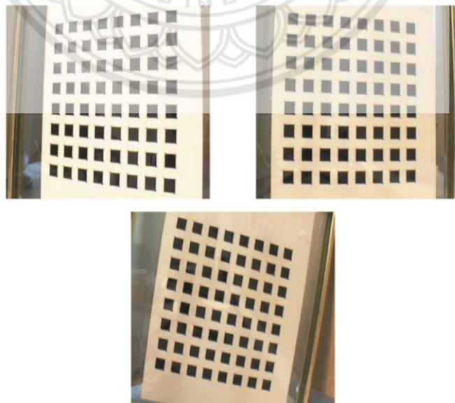
รูปที่ 2.12 รูปแบบแผ่นกระดานที่ใช้สำหรับการสอบเทียบกล้องของ Zhang [6]
