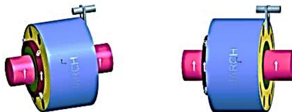
รูปที่ 2.24 การติดตั้งด้วยการสวมแหวนลื่น (Slip ring) เข้ากับเพลา (Shaft)
