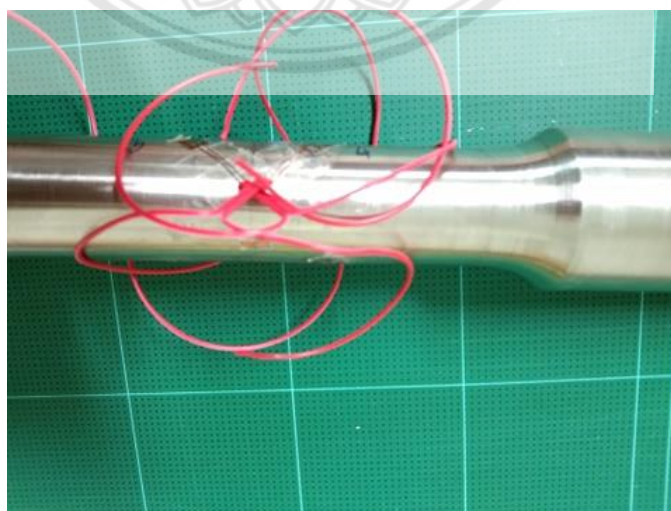
รูปที่ 3.31 ติด Stain Gauge Terminal ลงบนเพลลา
