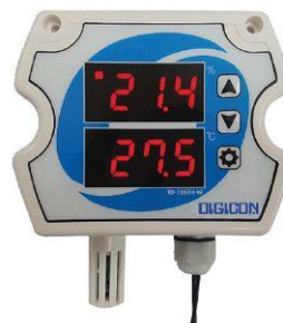
รูปที่ 2.9 เครื่องแปลงสัญญาณความชื้น [18]
