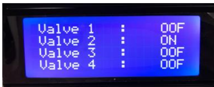
รูปที่ 3.28 จอแสดงผลเปิด-ปิดระบบวาล์ว
