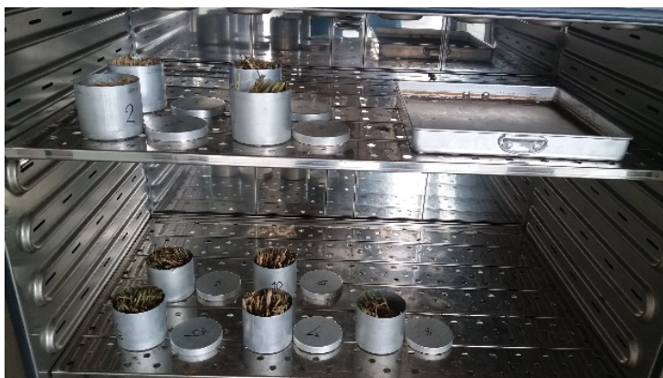
รูปที่ 3.5 นำฟางข้าวไปอบที่อุณหภูมิ 103°C
