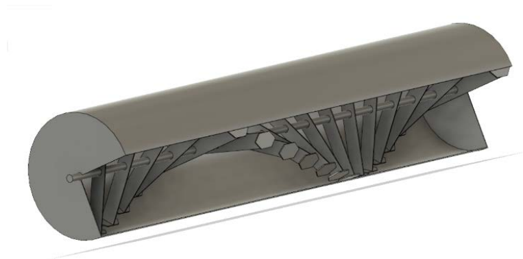
รูปที่ 3.14 แบบเครื่องสับฟางในแนวนอนแบบที่ 1
