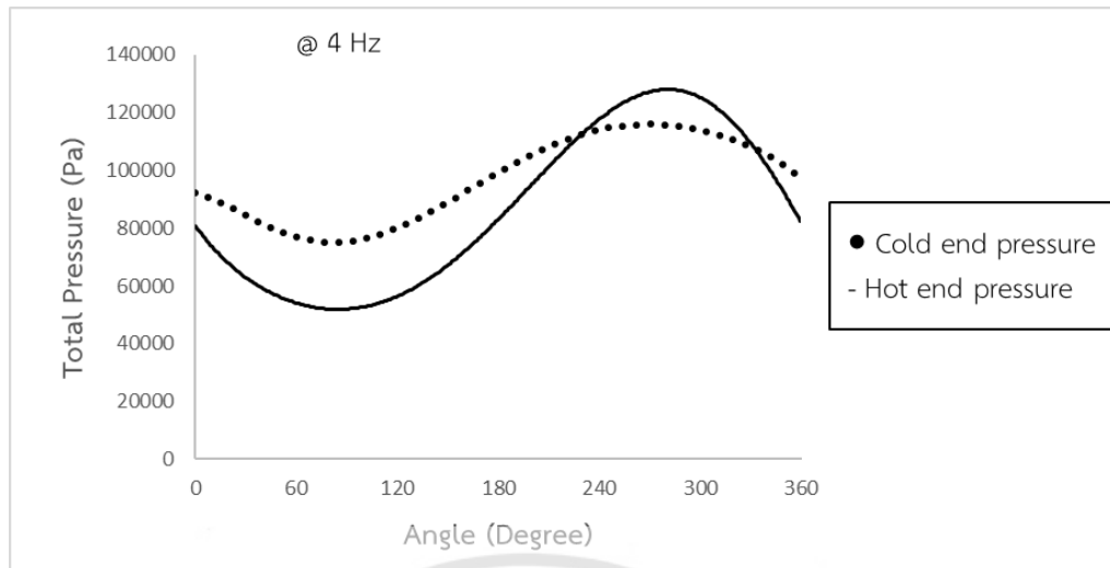
รูปที่ ก3 แสดงกราฟข้อมูลการเปลี่ยนแปลงความดันของสารทำงานที่ด้านรับความร้อนและทางด้านระบายความร้อนของรีเจนเนอเรเตอร์ ใช้แก๊บโลหะบาง ที่ความเร็วรอบ 4 Hz
