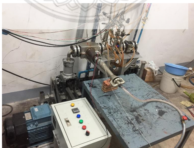
รูปที่ 3.1 ชุดทดสอบการไหลในรีเจนเนอเรเตอร์
