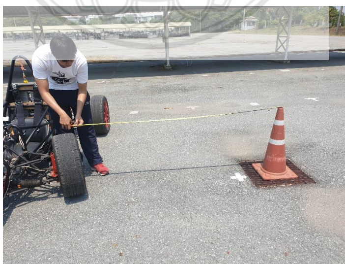
รูปที่ 3.30 การวัดเส้นผ่านศูนย์กลางวงกลมที่เกิดจากการกลิ้งของล้อ
