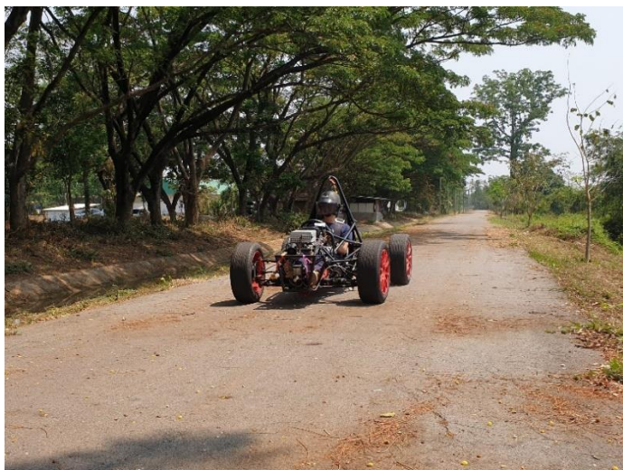
รูปที่ 3.25 การทดสอบระยะทางการวิ่งต่อการประจุไฟฟ้าหนึ่งครั้ง
