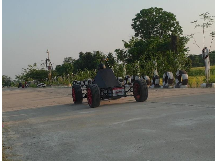
รูปที่ 3.34 การทดสอบหาการใช้พลังงานโดยเฉลี่ยของรถฟอร์มูล่าไฟฟ้าที่ความเร็วต่าง ๆ
