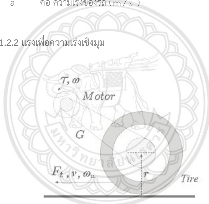
รูปที่ 2.3 ตัวอย่างการเชื่อมต่อมอเตอร์ไปยังล้อขับเคลื่อน
