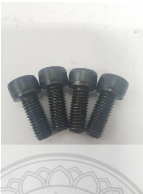
รูปภาคผนวก ก9 bolt ช่วยยึดแผ่น Support กันแรงจากการสกดน้ำมัน
