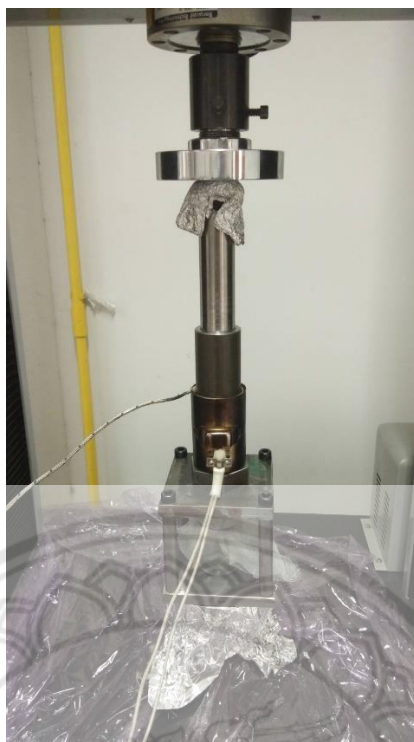
รูปภาพผนวก ก11 เครื่องสกัดเย็นแบบไฮดรอลิกที่ติดตั้งฮีตเตอร์และเทอร์โมคัปเปิลเสร็จเรียบร้อยแล้ว
