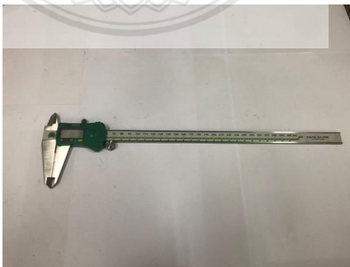
รูปที่ 3.5 เวอร์เนียคาลิปเปอร์แบบดิจิตอล
