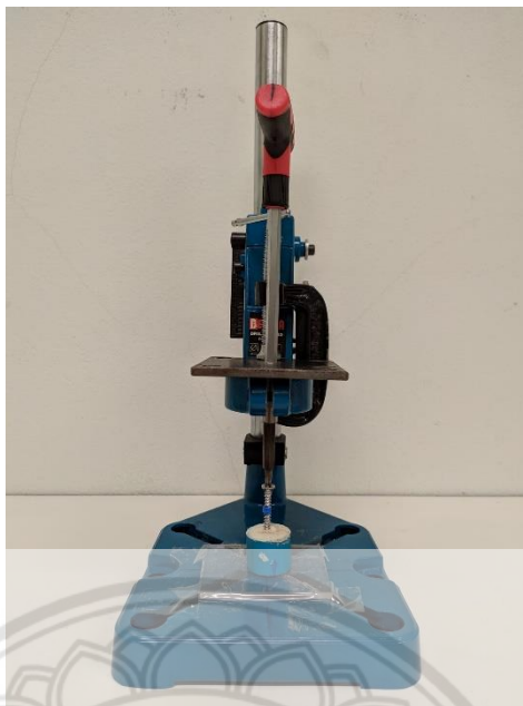
รูปที่ 3.13 การขันสกรูลงในซีเมนต์กระดุกกรณีไม่มีกระดุกเทียม
