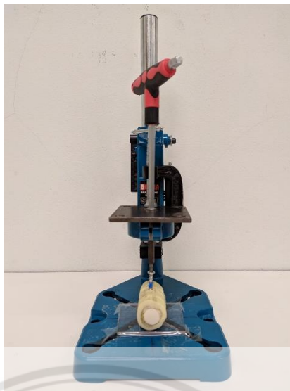
รูปที่ 3.12 การขันสกรูลงในซีเมนต์กระดุกกรณีมีกระดุกเทียม
