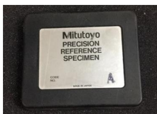
รูปที่ ข.4 ชิ้นงานมาตรฐานสำหรับสอบเทียบ
