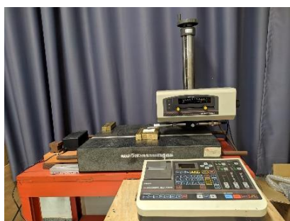
รูปที่ 3.8 เครื่องวัดความหยาบผิว (ยี่ห้อ Mituyoto รุ่น 480B)
