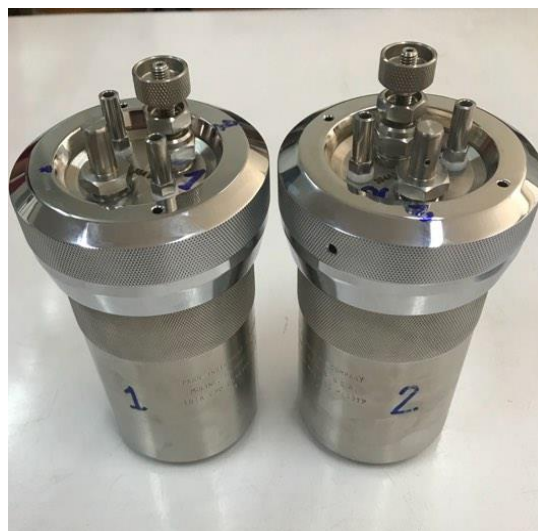
รูปที่ 3.44 ประกอบ Bomb Head เข้ากับลูกบอมบ์
