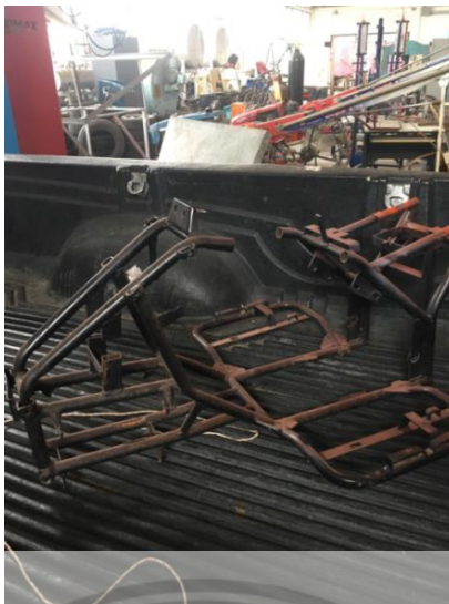
รูปที่ 15 โครงของรถ ATV ที่จะนำไปพัฒนาและออกแบบเป็นรถ Flexy
