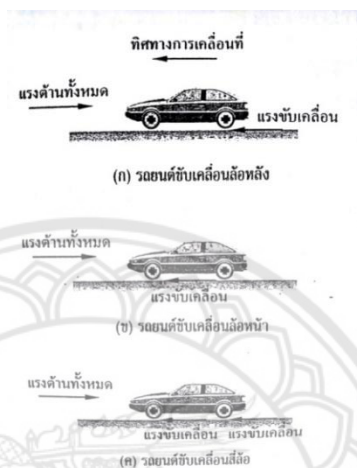
รูปที่ 1 แรงขับเคลื่อนเกิดขึ้นที่ผิวสัมผัสระหว่างยางกับถนนในขณะที่รถกำลังเคลื่อนที่
