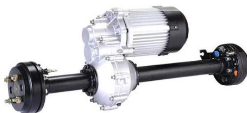
รูปที่ 6 แสดงโครงสร้างการวางตัวระหว่างมอเตอร์กับเพลาล้อหลัง
