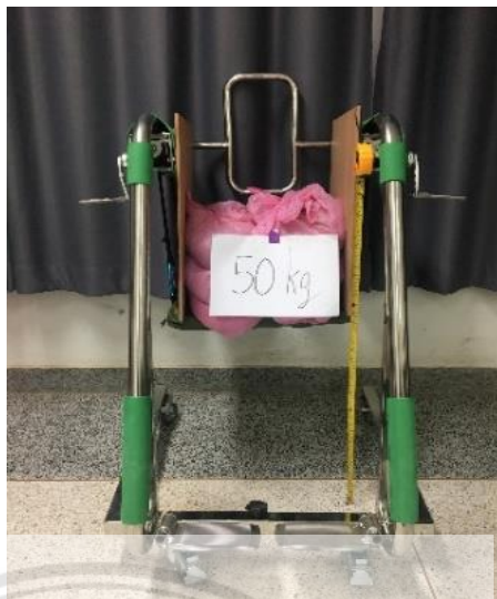
รูปที่ 4.28 วางถุงทรายลงบนเบาะรองนั่ง
