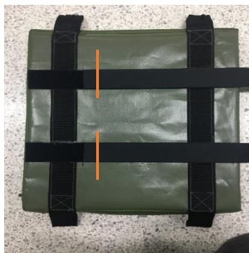
รูปที่ 4.6 ติดสายรั้งตรงบริเวณที่กำหนด
