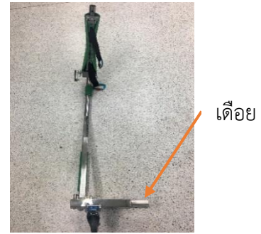
ก. รุ่นที่ 1 ข. รุ่นที่ 2 มีขนาดเดือยสั้นลง รูปที่ 4.22 เดือยของคานโครงสร้างของ Limo PTS รุ่นที่ 1 และรุ่นที่ 2
