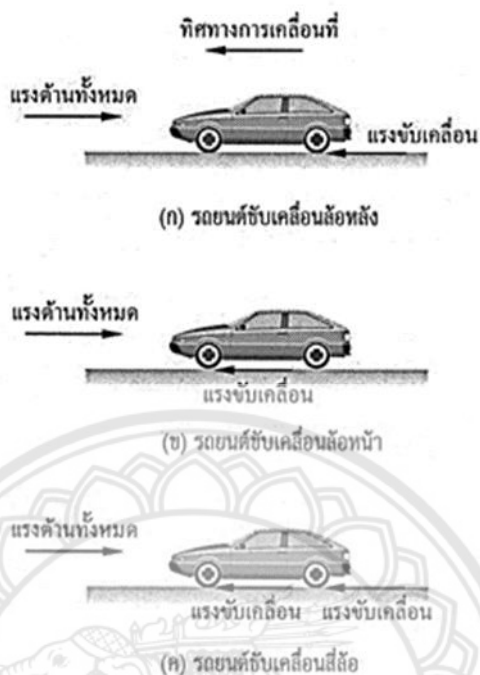
รูปที่ 2.4 แรงขับเคลื่อนที่ผิวสัมผัสระหว่างยางกับถนนในขณะที่ยานยนต์มีการเคลื่อนที่กับแรงต้านทั้งหมด ที่มา : http://www.auto2drive.com
