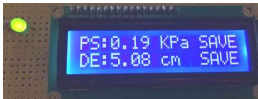
รูปที่ 4.16 อุปกรณ์ทำงานโดยกดปุ่มบันทึก และความลึกของอุปกรณ์อยู่ในช่วง 5 เซนติเมตร
