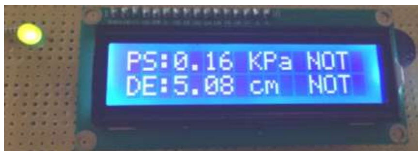
รูปที่ 4.17 อุปกรณ์ทำงานโดยไม่กดปุ่มบันทึก และความลึกของอุปกรณ์อยู่ในช่วง 5 เซนติเมตร
