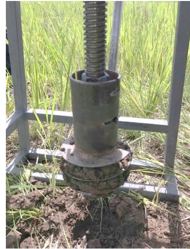
(ก) หมุนเกียร์เพื่อดึงชุดสกรูกับชุดกระบอกลง (ข) ชุดสกรูกับชุดกระบอกลงเก็บตัวอย่างดินที่ เก็บตัวอย่างดินขึ้นจากหลุม นำออกจากหลุม
