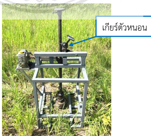
รูปที่ 3.20 การใช้งานอุปกรณ์เก็บตัวอย่างดินรูปแบบที่พัฒนา รุ่นที่ 1
