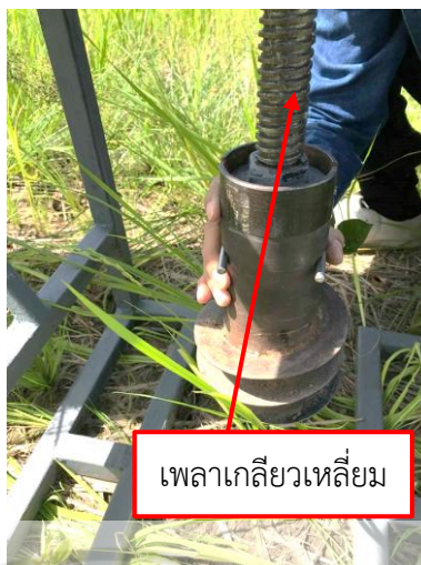
รูปที่ 3.19 การประกอบกระบอกเก็บตัวอย่างดินเข้ากับเพลาเกลียวเหลี่ยม
