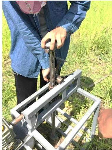
(ก) หมุนเกียร์เพื่อดึงชุดสกรูกับชุดกระบอกลง (ข) ชุดสกรูกับชุดกระบอกลงเก็บตัวอย่างดินที่ เก็บตัวอย่างดินขึ้นจากหลุม นำออกจากหลุม
