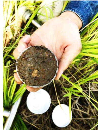
(ข) ลักษณะของดินที่ทำการปาดให้ผิวเรียบแล้ว
