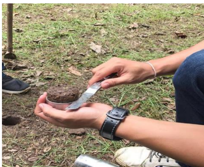
รูปที่ 2.11 การใช้คัตเตอร์ปาดหน้าดินที่เกินวงแหวนออก
