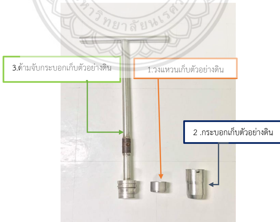
รูปที่ 3.1 ส่วนประกอบของอุปกรณ์เก็บตัวอย่างดินรูปแบบของ AIT
