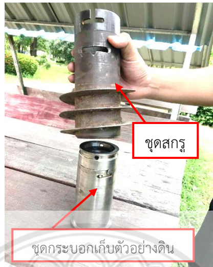
รูปที่ 3.17 การประกอบชุดสกรูกับชุดกระบอกเก็บตัวอย่างดิน
