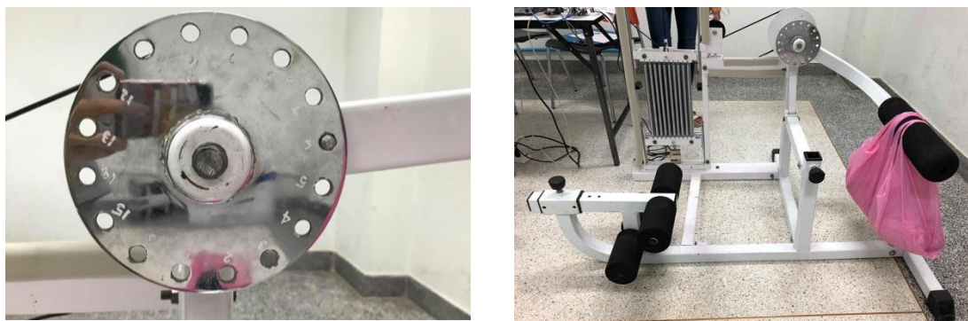
รูปที่ 3.22 ทดลองถ่วงมวล 10 กิโลกรัม
