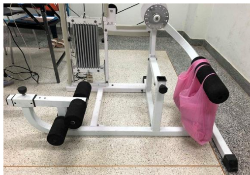
รูปที่ 3.24 ทดลองถ่วงมวล 20 กิโลกรัม
