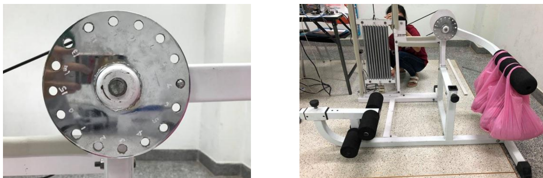
รูปที่ 3.23 ทดลองถ่วงมวล 15 กิโลกรัม
