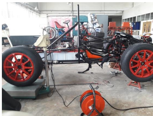
รูปที่ 3.21 การชั่งน้ำหนักรถต้นแบบเพื่อหาแรงปฏิกิริยาที่ล้อ
