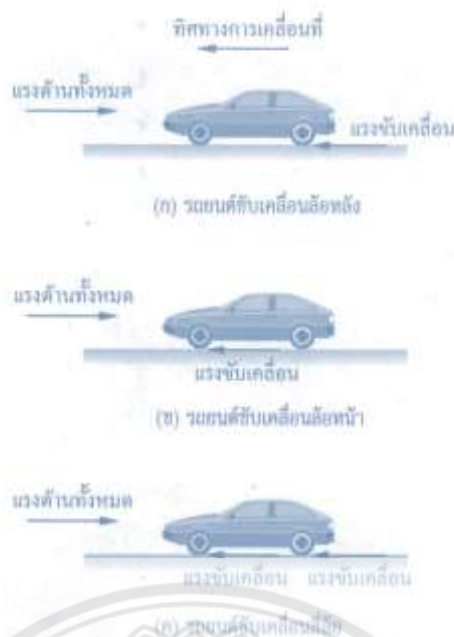
รูปที่ 2.3 แรงขบเคลื่อนที่ผิวสัมผัสระหว่างยางกับถนนในขณะที่ยานยนต์มีการเคลื่อนที่กับแรงดันทั้งหมด (ที่มา: http://www.auto2drive.com )
