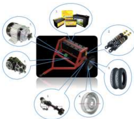
รูปที่ 2.2 ชิ้นส่วนที่สำคัญของชุดช่วยดันด้วยระบบไฟฟ้า
