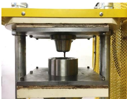
รูปที่ 4.26 ประกอบแม่พิมพ์โลหะเข้ากับเครื่องอัดขึ้นรูปด้วยความร้อน
