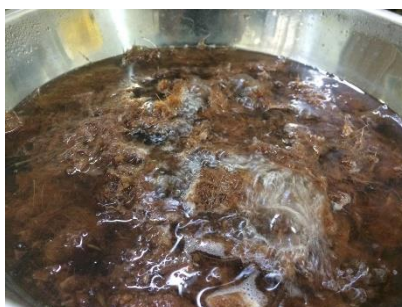
รูปที่ 3.17 ต้มเส้นใยกล้วยในน้ำอุณหภูมิ 100 องศาเซลเซียส
