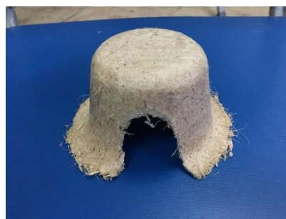
รูปที่ 3.31 กดอัดด้วยเครื่องอัดไฮดรอลิก
