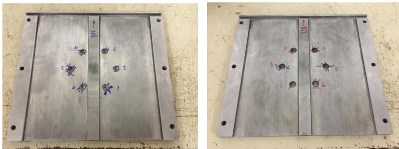
รูปที่ 4.23 ช่องใส่แผ่นให้ความร้อน ด้านล่างแผ่นเหล็กอัด
