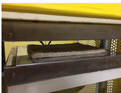
รูปที่ 3.21 กดอัดด้วยแรงดันและความร้อน
