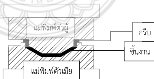
รูปที่ 2.4 แม่พิมพ์อัดชิ้นงานแบบราบ (Flat form) หรือชนิดบาง (Flash mold)
