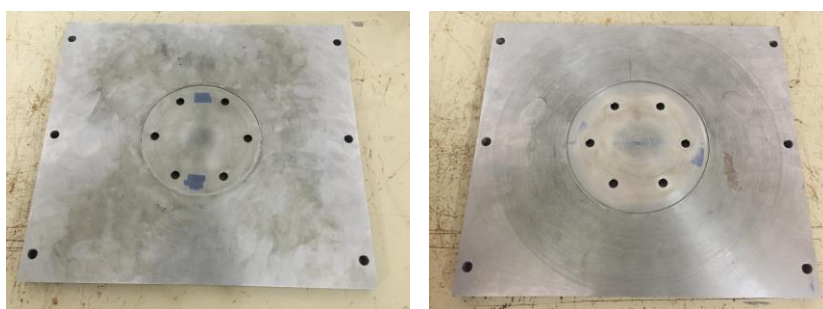
รูปที่ 4.22 แผ่นเหล็กอัด สำหรับติดตั้งแม่พิมพ์กับตัวเครื่องอัดขึ้นรูปด้วยความร้อน
