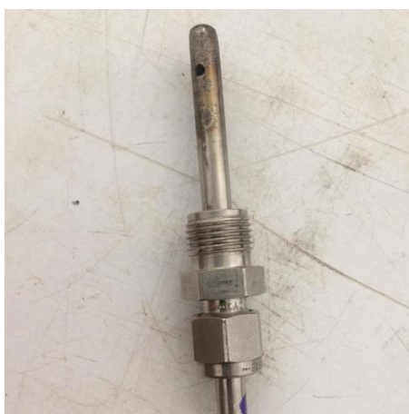
รูปที่ 3.14 ลักษณะของหัววัดการไหล (Pitot tube)
