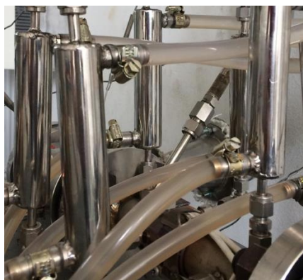
รูปที่ 3.6 แจ็คเก็ตน้ำสแตนเลส (Stainless Steel)
