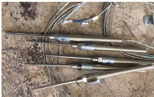
รูปที่ 3.15 หัววัดอุณหภูมิทางเข้าและออกกรีเจนเนอเรเตอร์ (Thermocouple)
