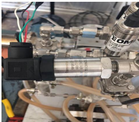
รูปที่ 3.12 หัววัดความดันแบบ Static pressure sensor
