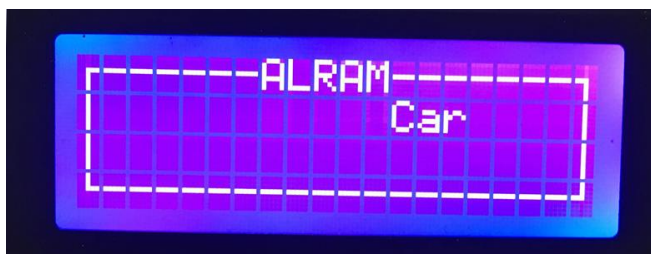
รูปที่ 3.19 รูปแบบหน้าจอเมื่อเซนเซอร์ตรวจพบสิ่งผิดปกติ
