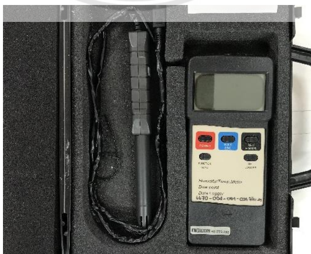
รูปที่ 3.19 เครื่องวัดความชื้นและอุณหภูมิ
