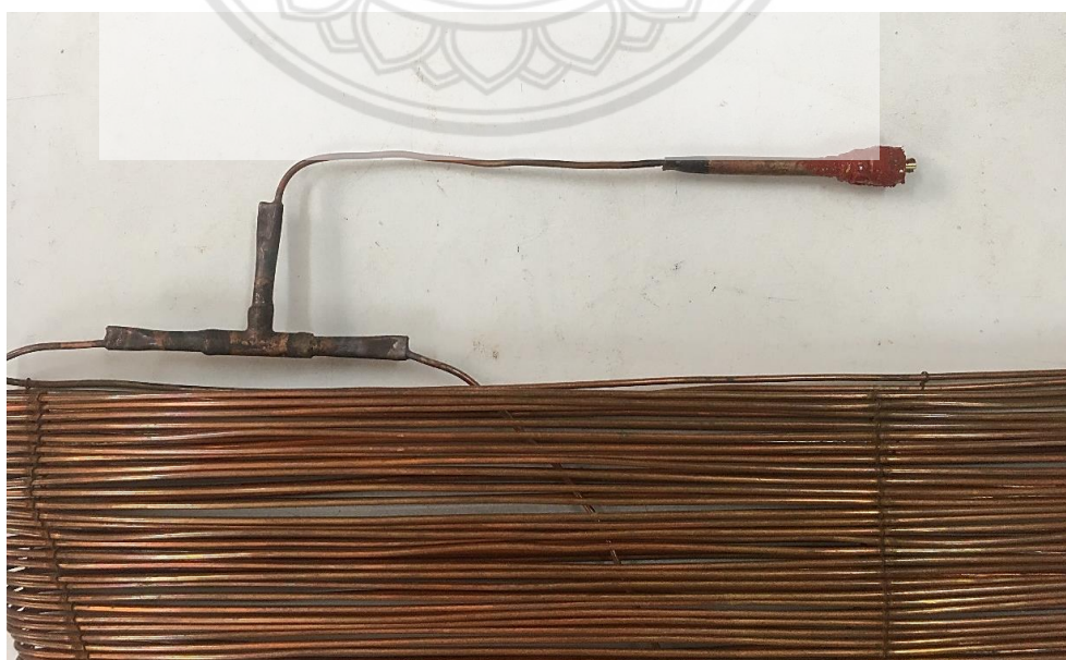
รูปที่ 3.7 เชื่อมท่อทองแดงติดกับข้อต่อ 3 ทาง ที่ใช้สำหรับเติมสารทำงาน
