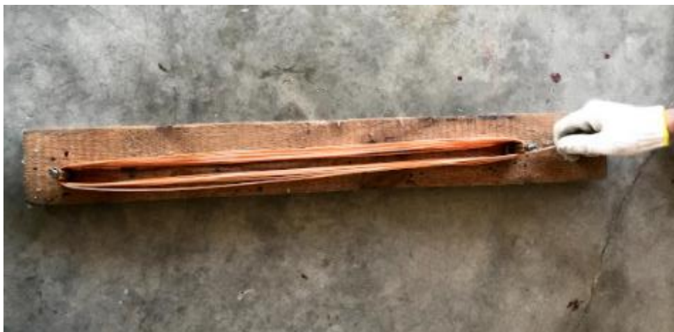
รูปที่ 3.4 การขดท่อทองแดงให้เป็นโค้งเลี้ยวรอบแท่งเหล็ก
